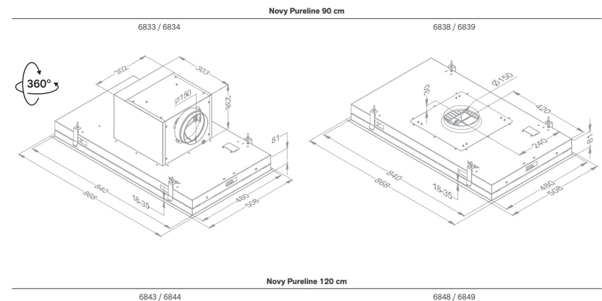
(1) La hotte doit être connectée avec le moteur dissocié extérieur 445.999 ou un moteur extérieur pour toiture plate (voir accessoires). Le débit d'air et le niveau sonore dépendent de l'installation.
