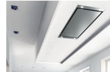
Le taux d'évasement des buées se situe entre 10° et 15°. Pour un fonctionnement optimal, il est important que la dimension de la construction dans laquelle le plafonnier est installé couvre au moins la largeur et la profondeur de la plaque de cuisson ainsi que l'évasement des buées: un débord d'environ 30 cm est conseillé. Faire un avaloir de 10 cm autour du coffrage permettra également de bloquer les buées.
