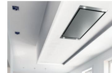
Kochdämpfe steigen nicht senkrecht nach oben, sondern werden über einen Winkel von 10° bis 15° fächerförmig verteilt. Für eine gute Absaugung der Wrasen muss die Dunstabzugshaube mindestens die volle Breite und Tiefe des Kochfeldes haben. Planen Sie innerhalb der Trockenbau-Konstruktion einen Rand von ca. 30 cm ein, um die optimale Funktion zu gewährleisten. Darüber hinaus sorgt ein 5 bis 10 cm hoher umlaufender Wrasenfangraum dafür, dass weniger Dämpfe entweichen können.
