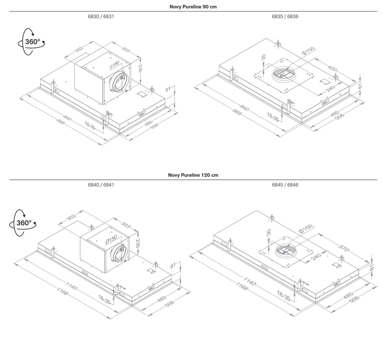
(1) Die Abzugshaube muss mit dem Wandmotor Typ 445.999 oder einem Flachdachmotor verbunden werden (siehe Zubehör). Luftmenge und freie Strömungen hängen von der Installation ab.
